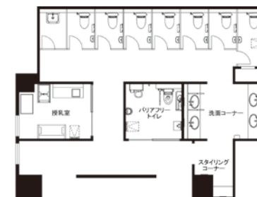
中ですれ違わないように配慮された「回遊型」の設計 画像提供/TOTO株式会社
